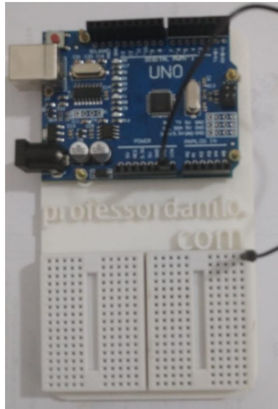
Figura 2: Note o cabo preto conectando uma linha da matriz de contato com o GND
