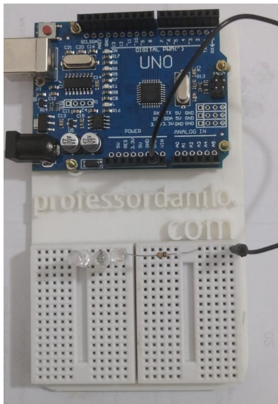
Figura 3: No GND o professor conectou três LEDs, nas cores verde, amarela e azul, olhando da direita para a esquerda. Lembre-se que o LED é polarizado e a perna mais curta deve ser conectada ao GND. O professor colocou, portanto, todos os LEDs com a perna menor do outro lado do resistor.
